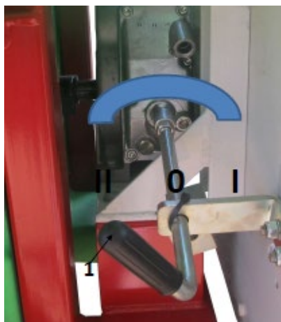
Rysunek 7. Widok przekładni przystawki wentylatorowej.
