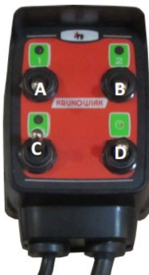
Rysunek 19. Panel sterowania układem cieczowym opryskiwacza.
