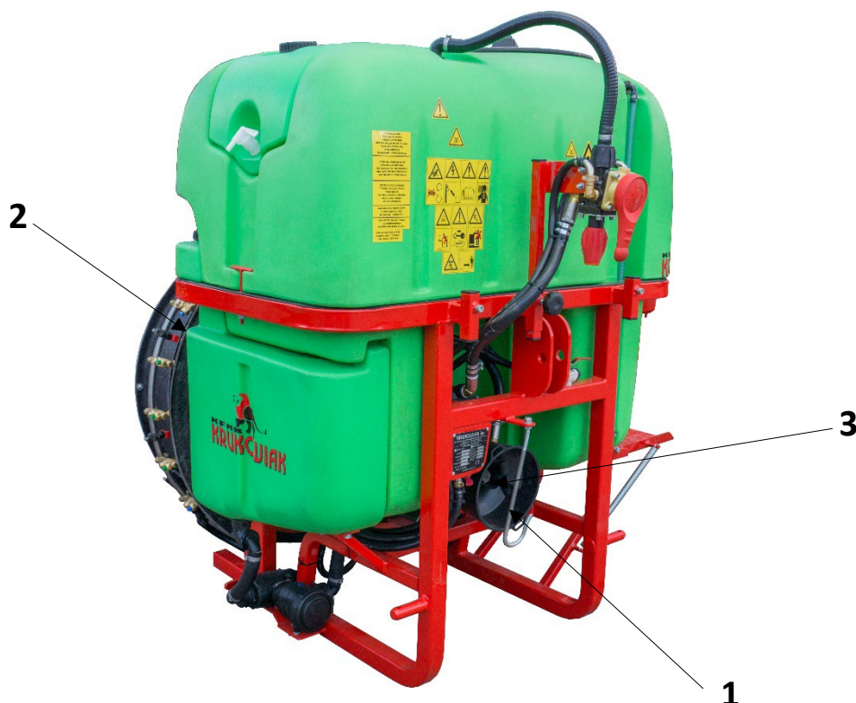
Rysunek 24. Punkty smarowania opryskiwacza zawieszanego sadowniczego TAJFUN.
